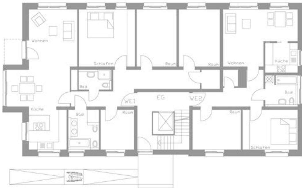
Abbildung 9: Villa Friedrichberg, Baugemeinschaft in Hamburg: EG mit barrierefreiem Zugang in Form einer Rampe und Aufzug im Treppenhaus und zwei Wohneinheiten
